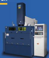
1x NeuAr. C1200 Verfahrwege: X= 1200 x Y = 700 x Z=1000 mm
