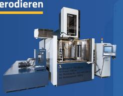
1x Excetek V1280 Z1005 Verfahrwege: X= 1200 x Y =800 x Z=1005 mm
